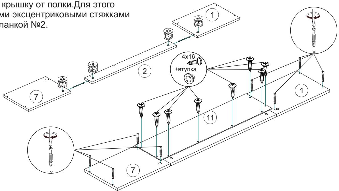
**4.**На собранную конструкцию наложите стекло №11.Используя шурупы4х16и втулки для стекла закрепите его на каркасе крышки.
