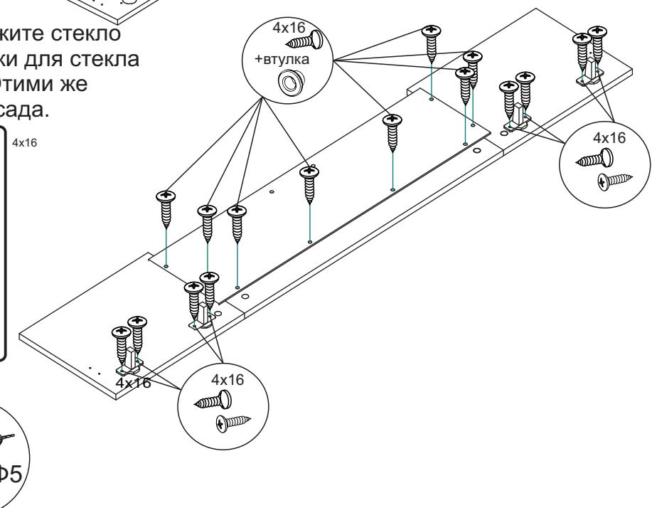
**8. Соедините собранный фасад с корпусом полки. Установите газовые лифты по схеме.**
