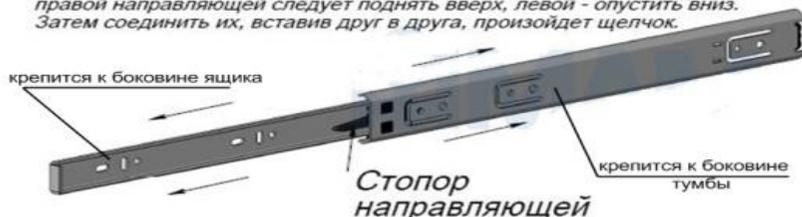
Рис.4 Схема установки шариковых направляющих
