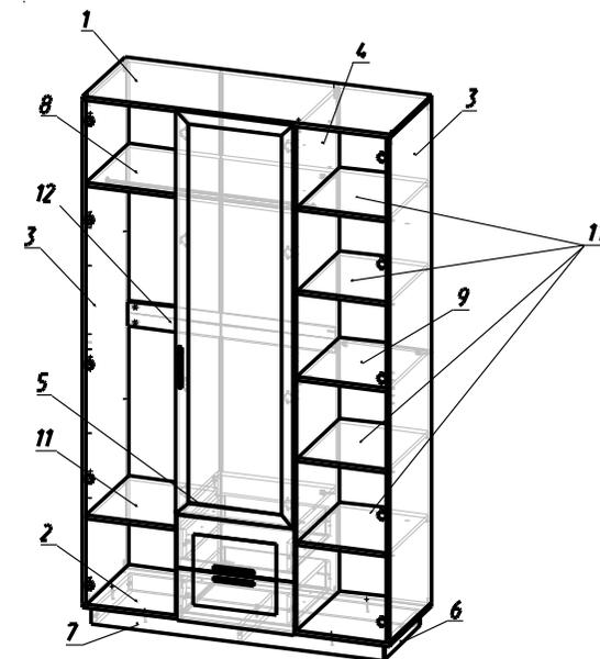
Рис.5 Схема сборки шкафа на другую сторону
