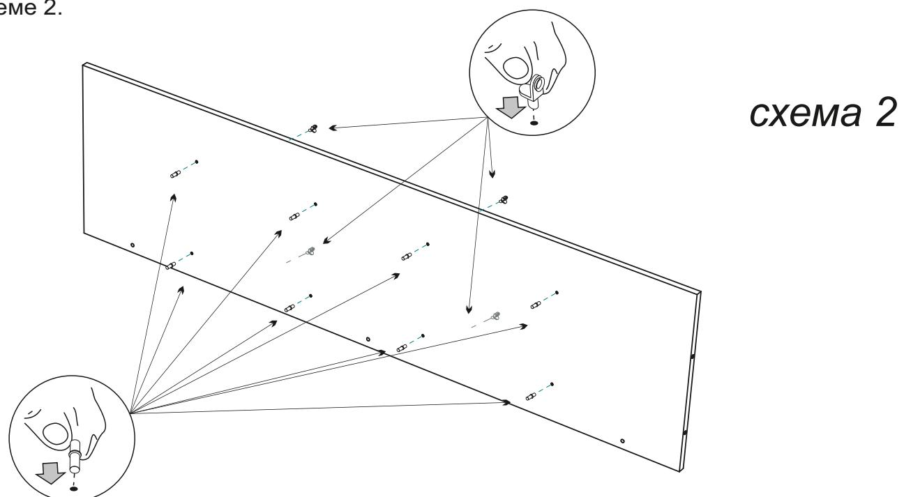
4. Соберите каркас шкафа. Для этого соедините боковины №1 и №2 евровинтами вязкой №10 и задней стенкой №4, затем ими же прикрепите крышки №8 и №9, перегородки №3 и №7, а планки №12, №13 и №14 прикрутите к крышкам шурупами 4x30, панель 3Д установите на шканты. Установите опоры на шурупах 4x25, как показано на схеме 3.
