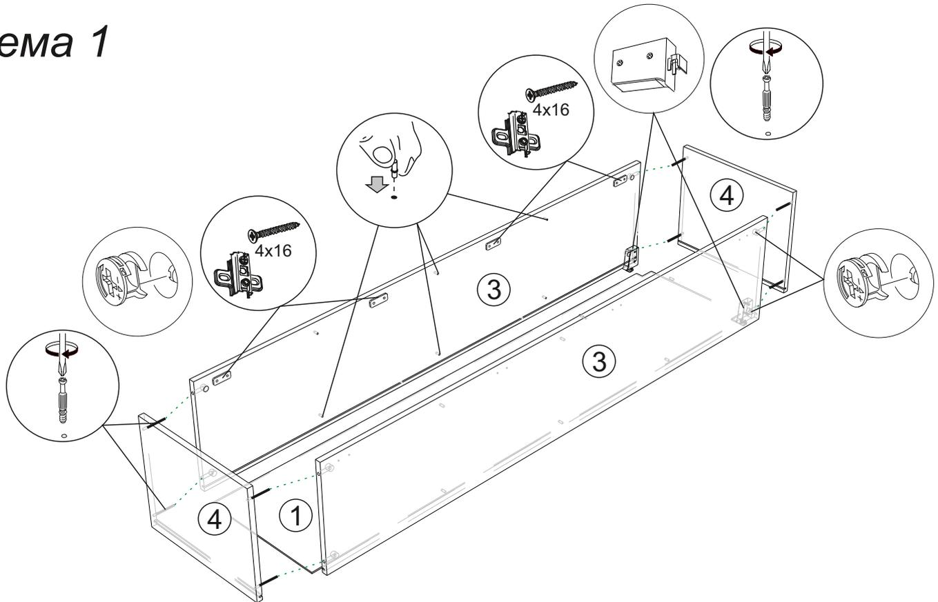
3. Переверните собранную конструкцию лицевой стороной вниз, уровняйте диагонали  $a=b$  и аккуратно не нарушая диагоналей закрепите заднюю стенку №1 к боковинам и крышкам с помощью уголков  $Rv8$  и шурупов  $4x16$  как показано на схеме 2.
