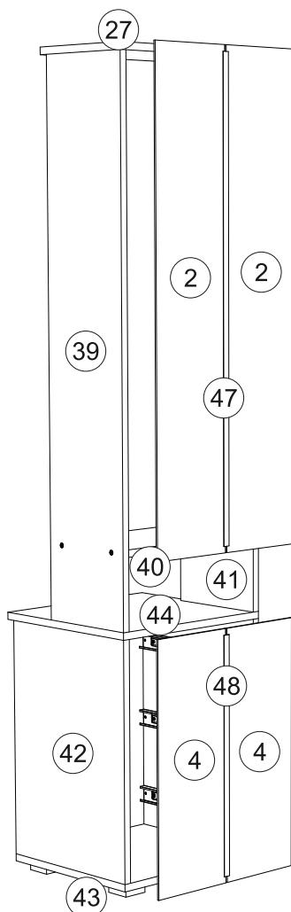
**30) Закрепить петли к створке 9 шурупами 4x16. Навесить готовую створку, закрепив петли к боковине 39(41), в зависимости от стороны открытия, используя шурупы 4x16. Установить ручку на створку 8, закрепив ее шурупами для ручки 3,5x30.**
