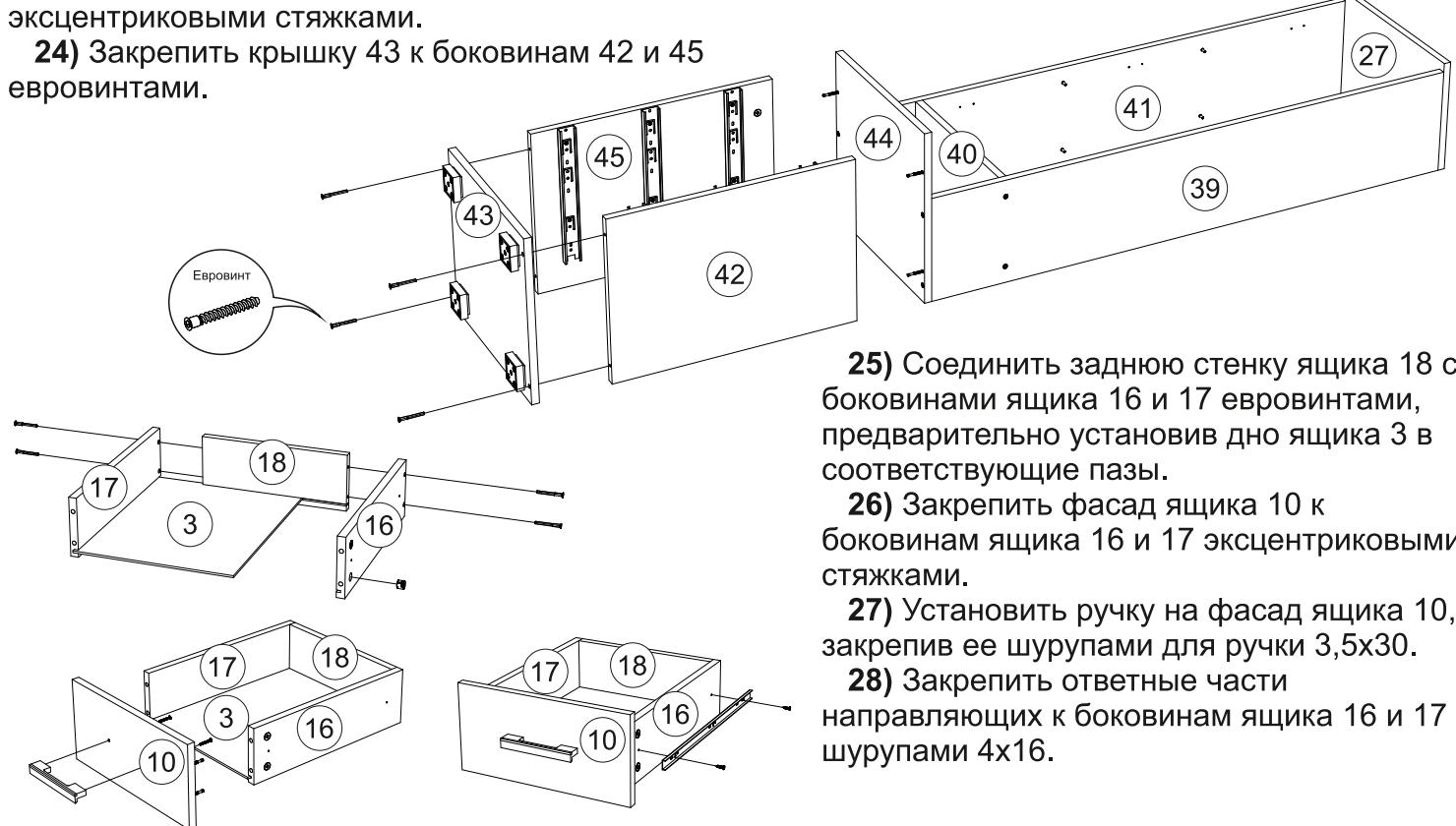
**25) Соединить заднюю стенку ящика 18 с боковинами ящика 16 и 17 евровинтами, предварительно установив дно ящика 3 в соответствующие пазы.**
