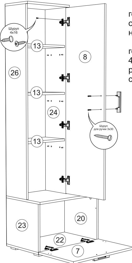
**15)** Закрепить петли к створке 8 шурупами 4x16. Навесить готовую створку, закрепив петли к боковине 24(26), в зависимости от стороны открытия, используя шурупы 4x16. Установить ручку на створку 8, закрепив ее шурупами для ручки 3,5x30.
