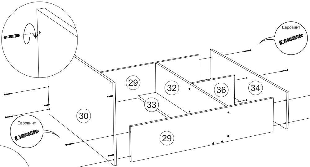
**3)** Закрепить крышку 30 к боковинам 29, и крышку 34 к боковинам 29 и к перегородке 36 при помощи евровинтов.
