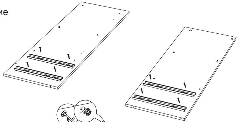
3. Соберите каркас шкафа. Для этого с помощью евровинтов соедините боковину №2 и перегородку №3 с вязкой №6.
