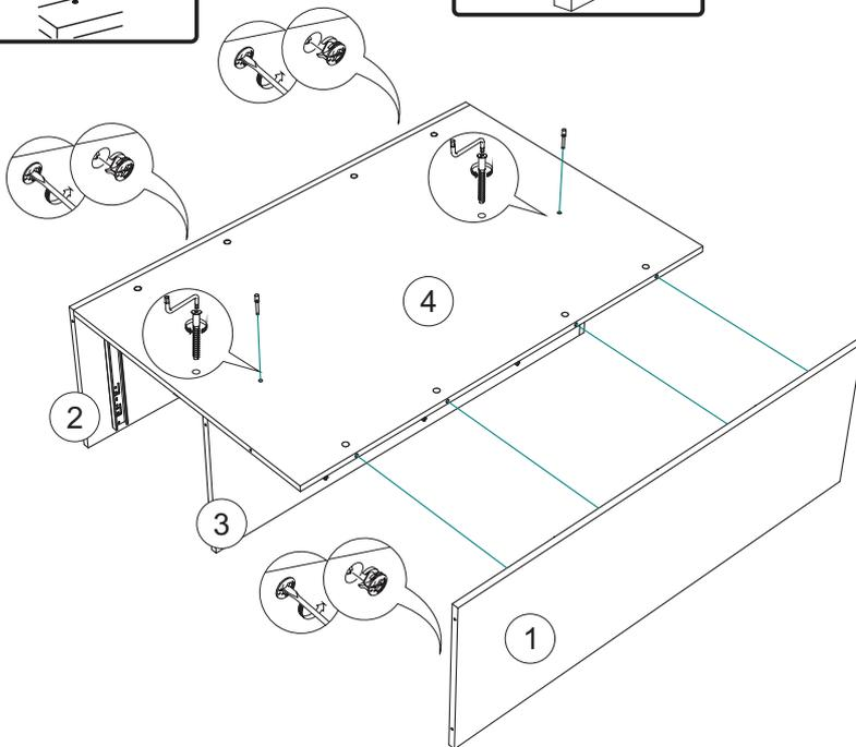
4. Установите заднюю стенку. Для это с помощью эксцентриковой стяжки соедините боковину №2 и заднюю стенку №4, затем заднюю стенку соедините евровинтами с перегородкой №3. После эксцентриковыми стяжками соедините заднюю стенку №4 с боковиной №1.
