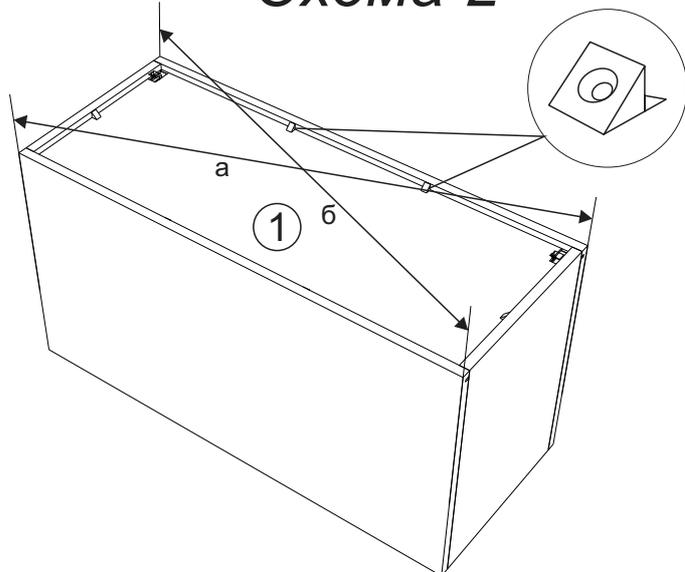
4. Закрепите монтажную шину к стене (крепеж в комплект не входит) навесьте собранный модуль, отрегулируйте положение модуля по высоте и глубине регулировочными винтами навесов. Затем закрепите к створке с помощью шурупов 4x16 петли и прикрепите створку к ответным планкам петель на крышке модуля, отрегулируйте и выставьте зазоры согласно схемы. Установите газлифты.
