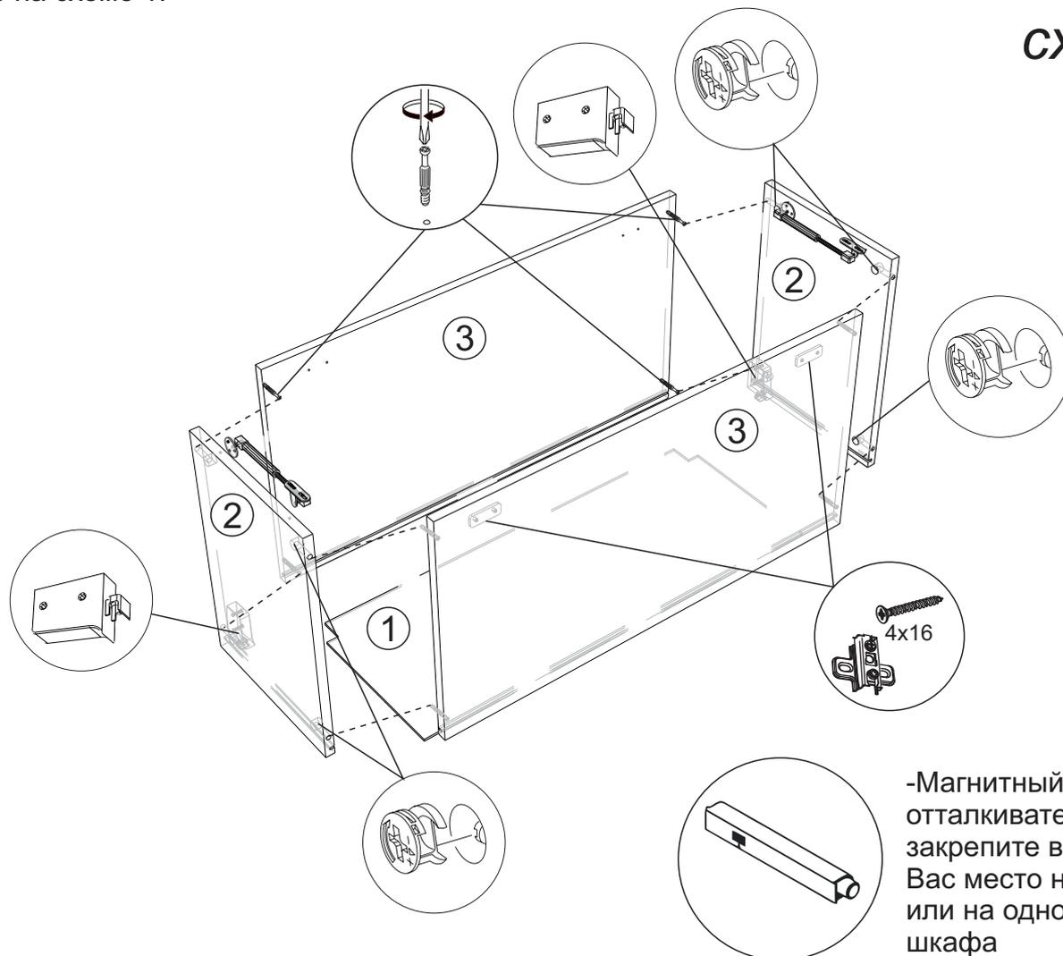
3. Переверните собранную конструкцию лицевой стороной вниз, уровняйте диагонали  $a=b$  и аккуратно не нарушая диагоналей закрепите задние стенки №1 к боковинам и крышкам с помощью уголков Rv8 и шурупов 4x16. как показано на схеме 2.
