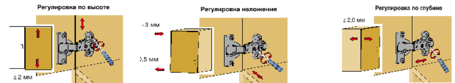
Рис.4 Схема регулировки петель
